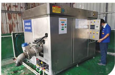
自動低溫蒸餾乾化設備
